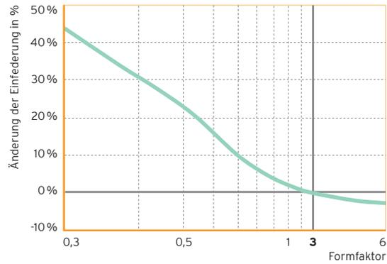
Abb. 6: Einfederung<sup>5</sup> in Abhängigkeit des Formfaktors
