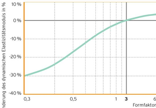
Abb. 7: Dynamischer Elastizitätsmodul<sup>5</sup> bei 10 Hz in Abhängigkeit des Formfaktors
