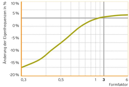
Abb. 8: Eigenfrequenz<sup>5</sup> in Abhängigkeit des Formfaktors
