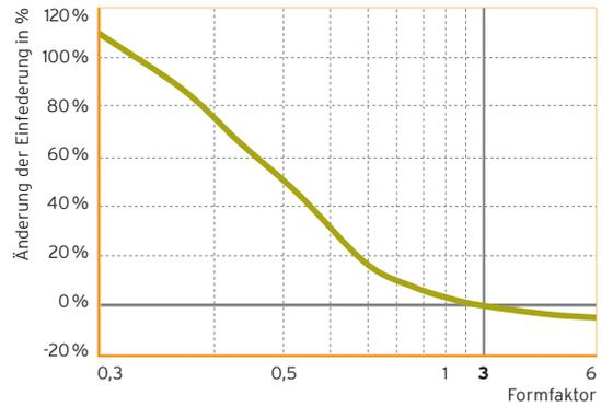
Abb. 6: Einfeldung<sup>5</sup> in Abhängigkeit des Formfaktors
