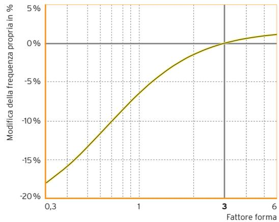
Fig. 8: Frequenza propria<sup>4</sup> in base al fattore forma
