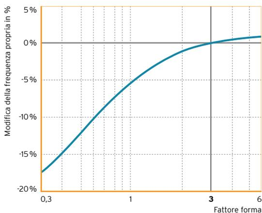
Fig. 8: Frequenza propria<sup>4</sup> in base al fattore forma
