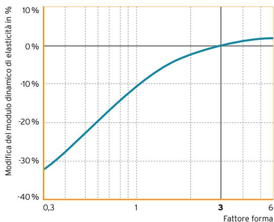
Fig. 7: Modulo dinamico di elasticità<sup>4</sup> a 10Hz in base al fattore forma
